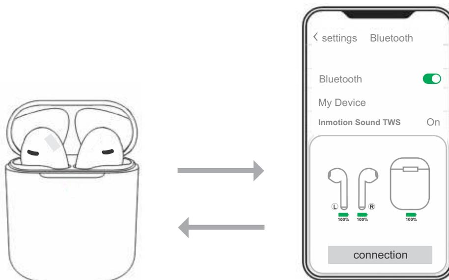
4. Quando o fone de ouvido é colocado no estojo de carregamento, entra automaticamente no modo de carregamento, e é desligado .
